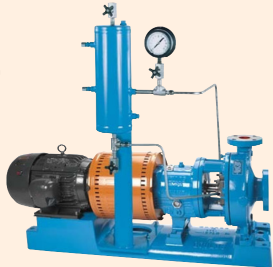
CPI PLAN 7353 La circulación presurizada lubrica caras dobles del sello.
